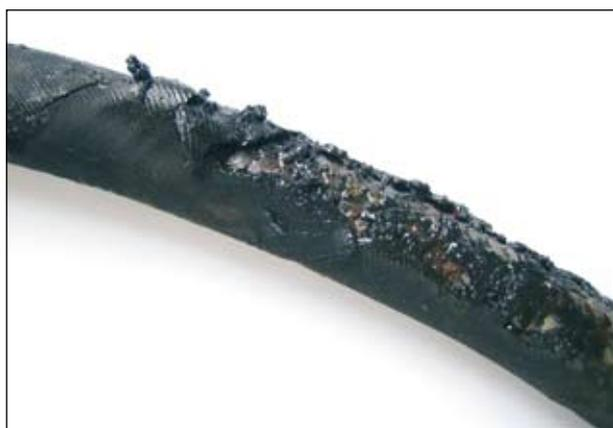
Caso di degradazione osservata seguito all'impiego di un prodotto classico di débituminage a base di ester metilico di colza
